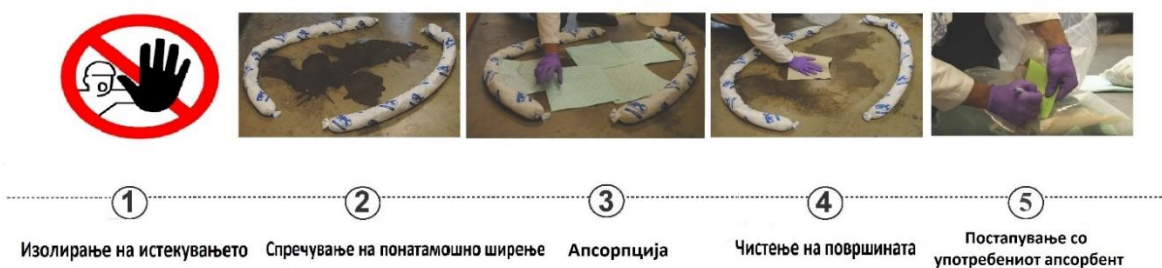
Слика 17 Шема на активности во случај на истекување на опасни/отпадни материји со примена на апсорбент
