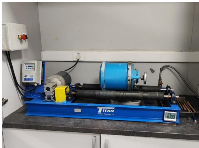
Слика 8 Лабораториски млин со шипки (дел од опремата во погонската лабораторија)
