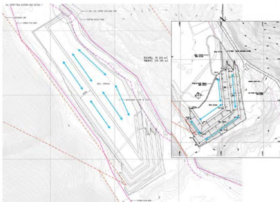
Слика 25 Провци на распростирање и набивање на јаловината
