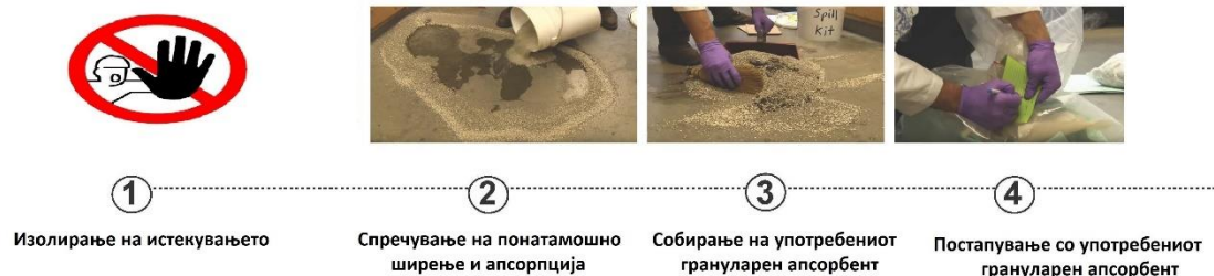
Слика 16 Шема на активности во случај на истекување на опасни/отпадни материји со примена на грануларен апсорбент
