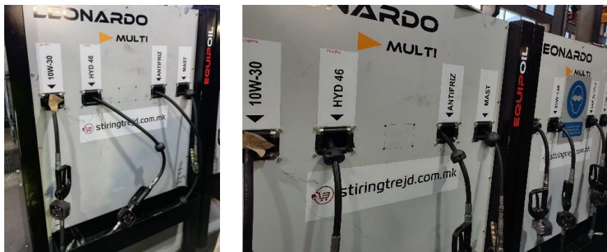
Слика 3 Пумпна станица за преточување на масла во сервисна работилница Епирос Шематскиот приказ на станицата за складирање, дистрибуција и преточување на масла во рамките на сервисната работилница е даден на следната слика.
