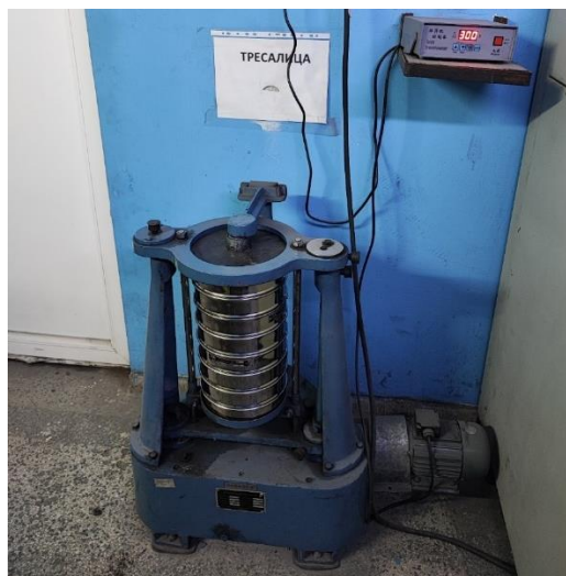
Слика 7 Ударно-ротациона тресалка за суво просејување (дел од опремата во погонската лабораторија)
